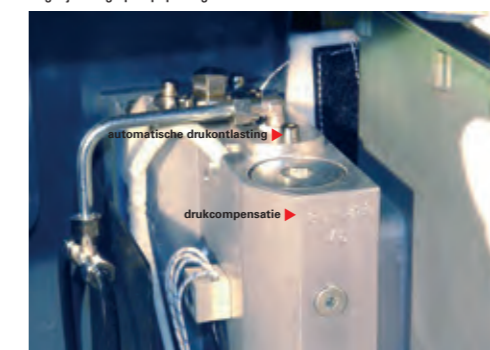
Dankzij het unieke compensatieventiel wordt in het omschakelpunt van de plunjerpomp de drukdaling in hoge mate verminderd en voorkomt dit een ongelijkmatig pomppbrengst.
