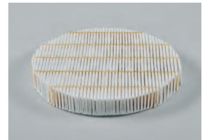
Afbeelding 1: Invloeden op het afkoelproces van een hotmelt lijmrups. Hoe groter het oppervlak ten opzichte van volume Q, des te sneller koelt de hotmelt lijm af.
