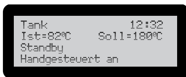
Bild 5.3/2: Anzeige im „Standby“-Betrieb
