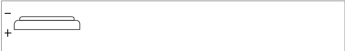
Bild 8.3/6: Polarität der Stützbatterie
