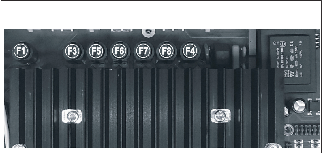
Foto 79.1/1: Positie van de zekeringen in het voedingseenheid
