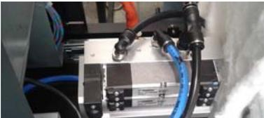
1. Den Schalter des Geräts an der Schaltschranktür neben dem Druckregler abschalten. Das Druckentlastungsventil schaltet den Hydraulikkreis druckfrei und führt den Kleber in den Behälter zurück.
