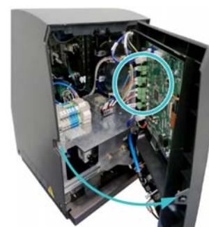
3. Signalkabel (max. Ø 14 mm) über die hintere Kabeldurchführung des Geräts (P) einführen und an der inneren Verankerung befestigen. Dabei darauf achten, dass das Kabel bis zu den entsprechenden Klemmen reicht.
