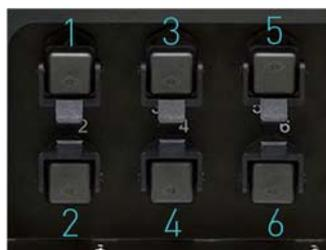
Die Schmelzgeräte der Serie ‚HB 6000 connect‘ sind mit einem Hydraulikverteiler mit maximal 6 möglichen Abgängen ausgestattet. Die Schläuche gemäß der Nummerierung auf der Zeichnung sachgemäß an den Verteiler anschließen.
