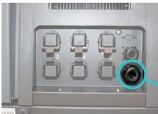
Die Tür des Elektroschranks so weit wie möglich öffnen. Das Leistungskabel (max. Ø18mm) durch die Kabeldurchführung (P) führen und an der Innenverankerung befestigen. Dabei darauf achten, dass das Kabel bis zum Stecker der Leistungskarte reicht, wo es installiert wird.
